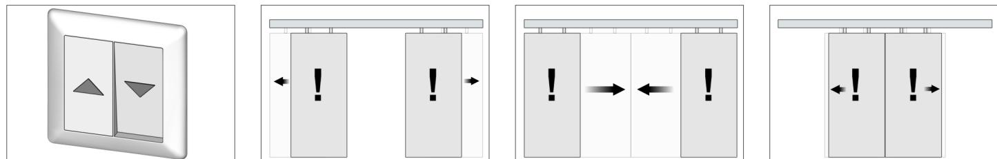
Die Lernfahrt wird dann eingeleitet, indem einer der beiden Taster kurz betätigt wird. Die Flügel verfahren langsam, bis sie gegen die Endlage stoßen und fahren anschließend in die andere Richtung, bis sie auch dort gegen die Endlage stoßen. Damit ist die Lernfahrt abgeschlossen.
