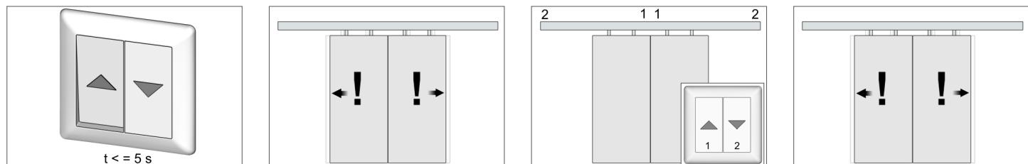
Die Fahrtrichtung kann innerhalb von 5 Sekunden gewählt werden, nachdem die Lernfahrt beendet wurde. Durch kurzes Betätigen einer der Taster wird die aktuelle Stellung diesem Taster zugeordnet. Mit dem anderen Taster wird dann entsprechend die andere Stellung angefahren. Die erfolgreiche Auswahl wird durch kurzes Reversieren der Flügel bestätigt.
