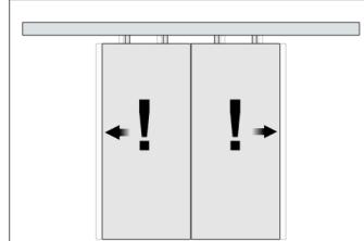
Der automatische Zulauf kann innerhalb eines Zeitfensters von 5 Sekunden eingestellt werden, nachdem die Fahrtrichtung ausgewählt wurde. Wird diese nicht ausgewählt, lässt sich auch der automatische Zulauf nicht einstellen. Die Aktivierung erfolgt durch kurzes Betätigen des Tasters, der die Tür öffnet. Die Aktivierung des automatischen Zulaufs wird durch kurzes Reversieren der Flügel bestätigt.
