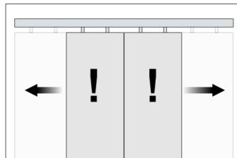
Im Impulsbetrieb fahren die Flügel nach der Erteilung eines Fahrbefehls automatisch in die jeweilige Endlage. Um die Flügel wieder anzuhalten, kann einer der beiden Taster betätigt werden.
