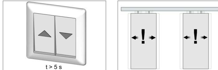
Um die Lernfahrt durchzuführen muss der Antrieb zunächst in den Lernmodus versetzt werden. Im Auslieferungszustand ist dieser Modus bereits aktiv. Ist der Modus nicht aktiv, so kann er durch gleichzeitiges Drücken beider Taster für mindestens 5 Sekunden aktiviert werden. Die Aktivierung des Lernmodus wird durch kurzes Reversieren (kurze Bewegung) der Flügel bestätigt. Dabei wird sowohl der automatische Zulauf deaktiviert, als auch die geöffnete Stellung gelöscht.
